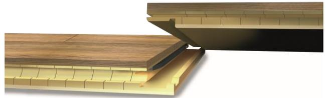
**Jede Diele kann einzeln heruntergedrückt werden, ohne die Reihe zu beenden. Eine flexible Feder rastet beim Herunterdrücken ein und gibt ein Klick-Geräusch ab.**
